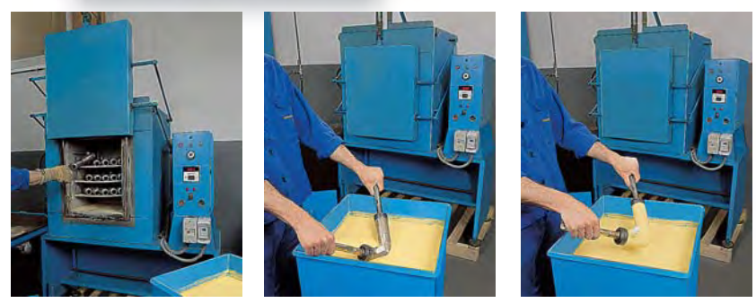
НАНЕСЕНИЕ АНТИКОРРОЗИОННОГО ПОКРЫТИЯ
